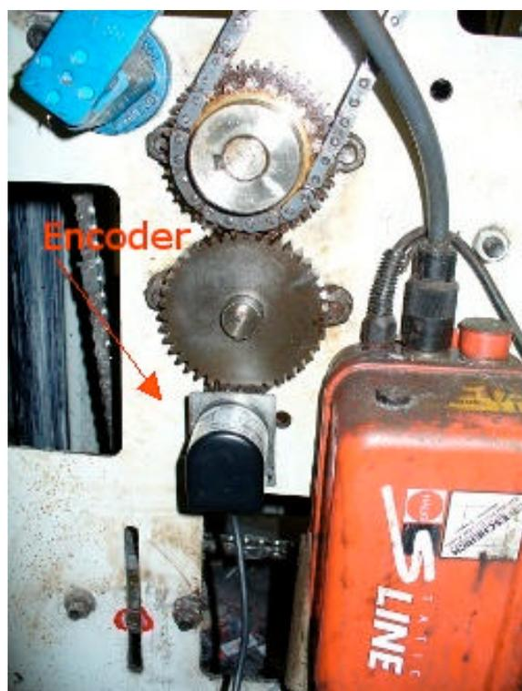
Esempio montaggio encoder su trasmissione modulo hot foil
